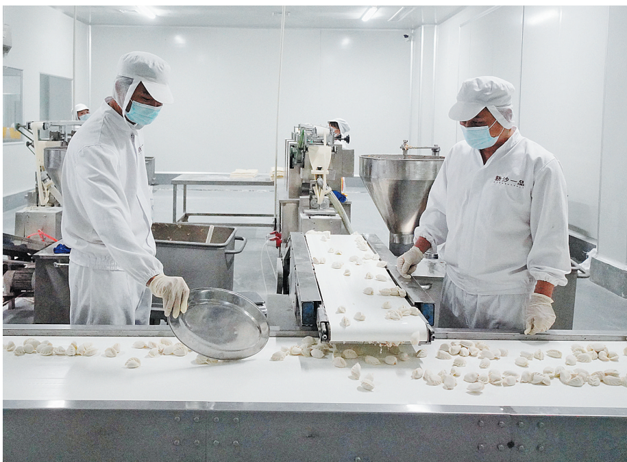
标准化蒸饺在中央厨房自动化生产线上速冻后装袋出库。(周志鸿 摄)
